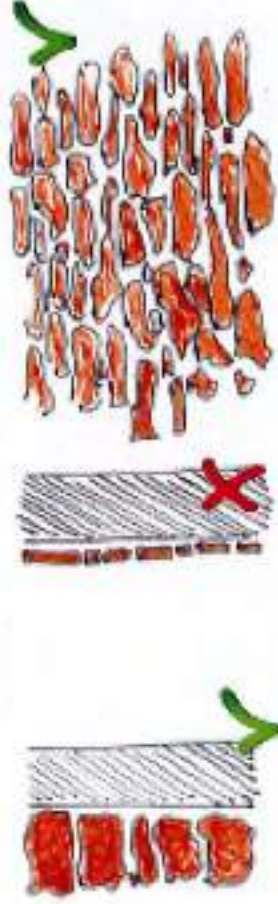
1. Enduit pierre recouverte - 2. Plâtre à l'extérieur - 3. Appareil traditionnel en pierre
