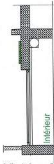
Coffre situé en applique côté intérieur. Le volet descend à l'intérieur. Cas de la vitrine en feuillure
