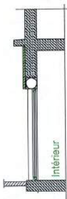
Coffre situé dans l'épaisseur du mur et masqué par l'enseigne. Le volet descend à l'extérieur.
