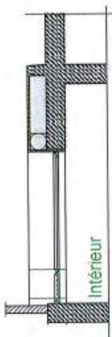
Coffre situé dans l'épaisseur du mur et masqué par le bandeau de la vitrine en applique. Le volet descend à l'extérieur.
