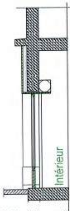
Coffre situé en applique côté intérieur. Le volet descend à l'intérieur. Cas de la vitrine en applique
