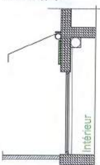
Enrouleur du store banne sous une corniche métal rapportée si le bâtiment n'en comporte pas
